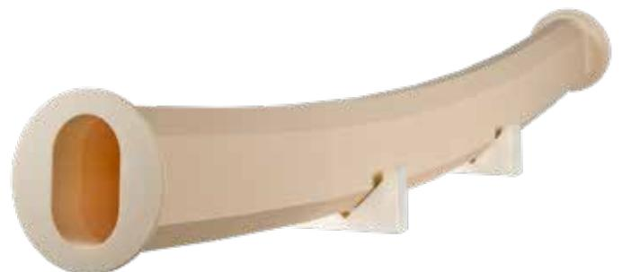
Abb. 2: Gebogene Vakuumkammer mit glasgelöteten Keramik-Keramik-Verbindungen, Biegewinkel: 15°, L 3.200 mm
